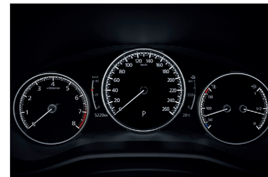
แผงหน้าปัด และมาตรวัดดิจิทัล แบบ TFT LCD พร้อมจอแสดงผลแบบสี ขนาด 7 นิ้ว
