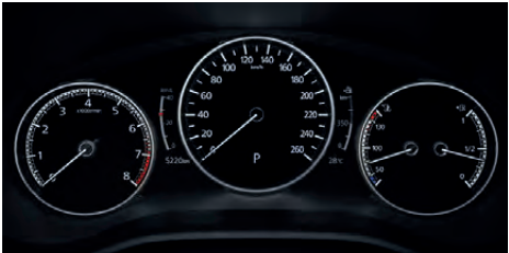
แผงหน้าปัด และมาตรวัดดิจิทัล แบบ TFT LCD พร้อมจอแสดงผลแบบสี MID (Multi Information Display)
